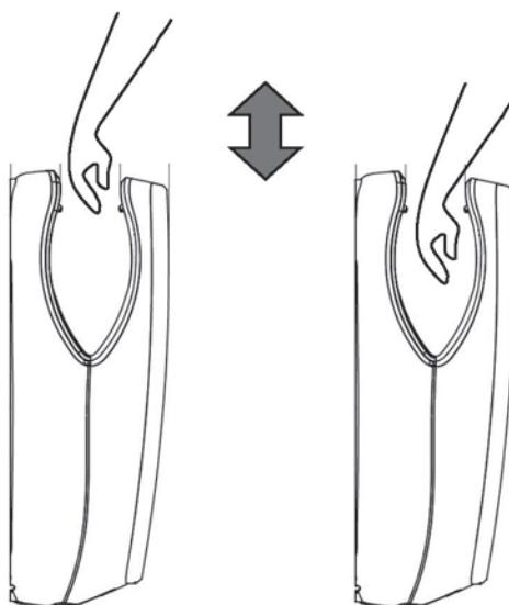
Quand le moteur se met en marche, un compte à rebours visible dans l'affichage de l'appareil sous forme de barres commence. Le temps idéal de séchage correspond au cycle de compte à rebours des dites barres. Cependant, si l'usager souhaite un temps de séchage plus long, un autre cycle commence automatiquement sans avoir à sortir et à réintroduire les mains. Le temps maximal de séchage est de 30 secondes.
